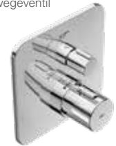
Badethermostat Unterputz nicht eigensicher, alternativ mit Sicherungskombination, eigensicher nach DVGW, mit integrierter Vorab- spernung, Rückflussverhinderer und Zweiwegeventil
